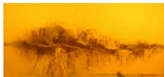
Simulation de pénétration dans un bloc de gélatine - .30-06 HIT à 100m
