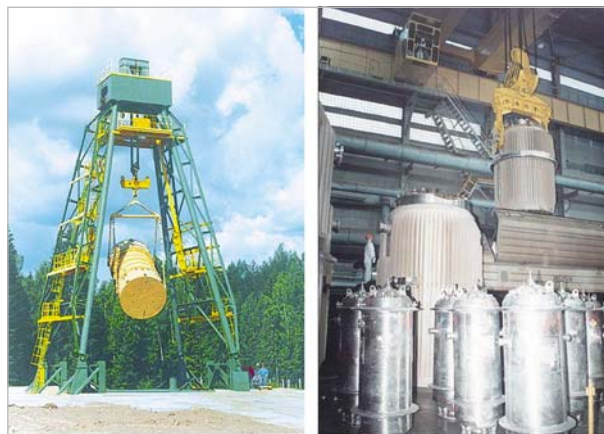
Рис. 2.2.2-1. Испытание и использование стандартных ТУК для перевозки ОЯТ
