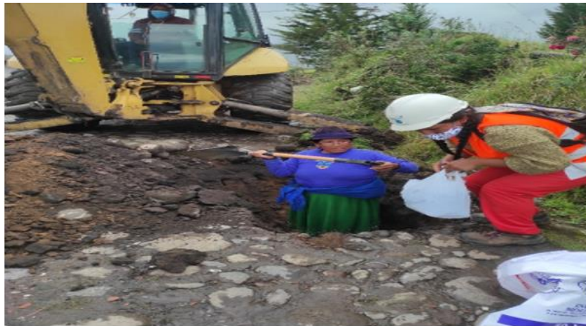
Gráfico 28. Extracción de muestras de suelo con maquinaria
