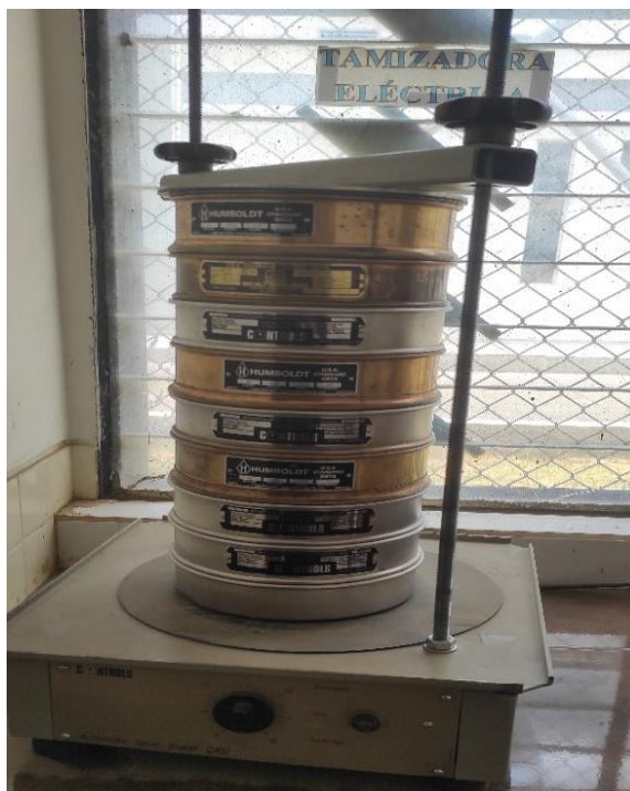
Gráfico 31. Granulometría, Proceso de tamizado en la tamizadora eléctrica.
