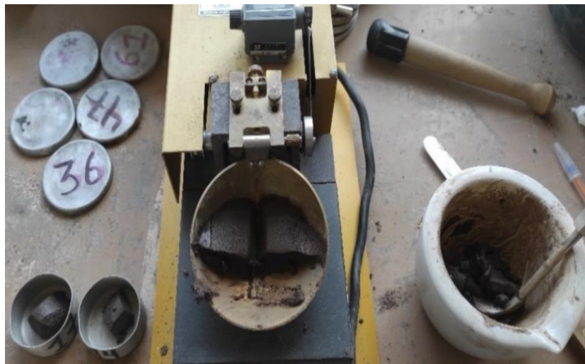
Gráfico 34. Proceso de ensayo en la copa de casa grande
