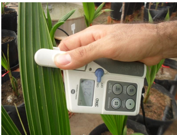
Figura 3 – Aferição dos teores relativos de clorofila total através do índice Spad. Fortaleza, Ceará, 2013/2014
