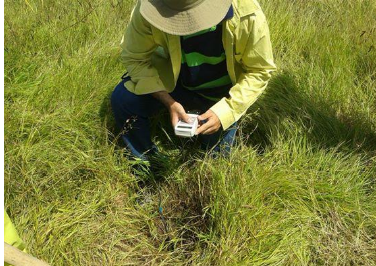
Figura 7 - Medição in situ da salinidade do solo com o sensor Wet sensor HH2 Moisture Meter® (AT delta – T Devices, Cambridge, England). Morada Nova, Ceará, 2013
