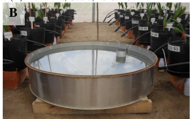
Figura 2 - Data-logger da marca Onset, modelo Hobo ® para a determinação dos dados de temperatura, umidade relativa do ar e luminosidade instalado no interior da casa de vegetação (A). Tanque evaporímetro do tipo Classe “A” instalado no interior da casa de vegetação para fins de monitoramento e de manejo da irrigação (B). Fortaleza, Ceará, 2013/ 2014
