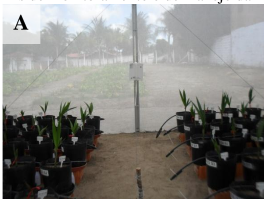
Figura 2 - Data-logger da marca Onset, modelo Hobo ® para a determinação dos dados de temperatura, umidade relativa do ar e luminosidade instalado no interior da casa de vegetação (A). Tanque evaporímetro do tipo Classe “A” instalado no interior da casa de vegetação para fins de monitoramento e de manejo da irrigação (B). Fortaleza, Ceará, 2013/ 2014
