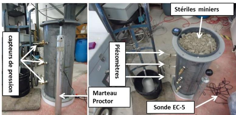
**Figure 3-2** : Montage des essais de perméabilité en colonne
