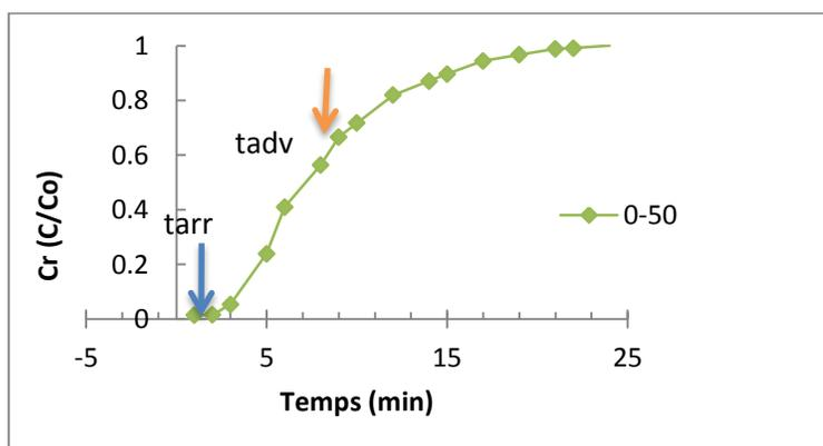
**Figure 3-15:** Courbe d'apparition du traceur stériles Bousquet 0-50 mm
