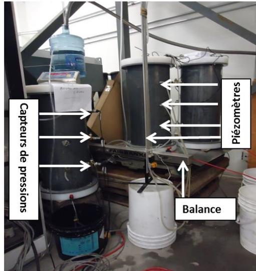
**Figure 3-3:** Déroulement des essais de perméabilité en colonne
