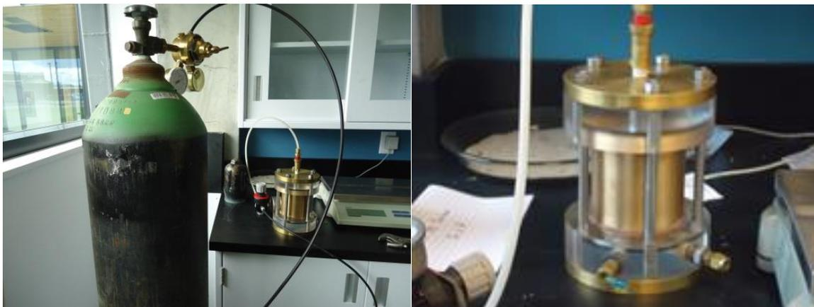
**Figure 3-5** : Essais de rétention d'eau en cellule Tempe
