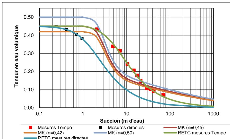
**Figure 3-18** : CRE obtenues par mesures expérimentales en cellules de Tempe et par mesures directes, lissées avec le logiciel RETC et prédites avec le modèle de Kovács modifié (MK) pour le résidu désulfuré LaRonde.
