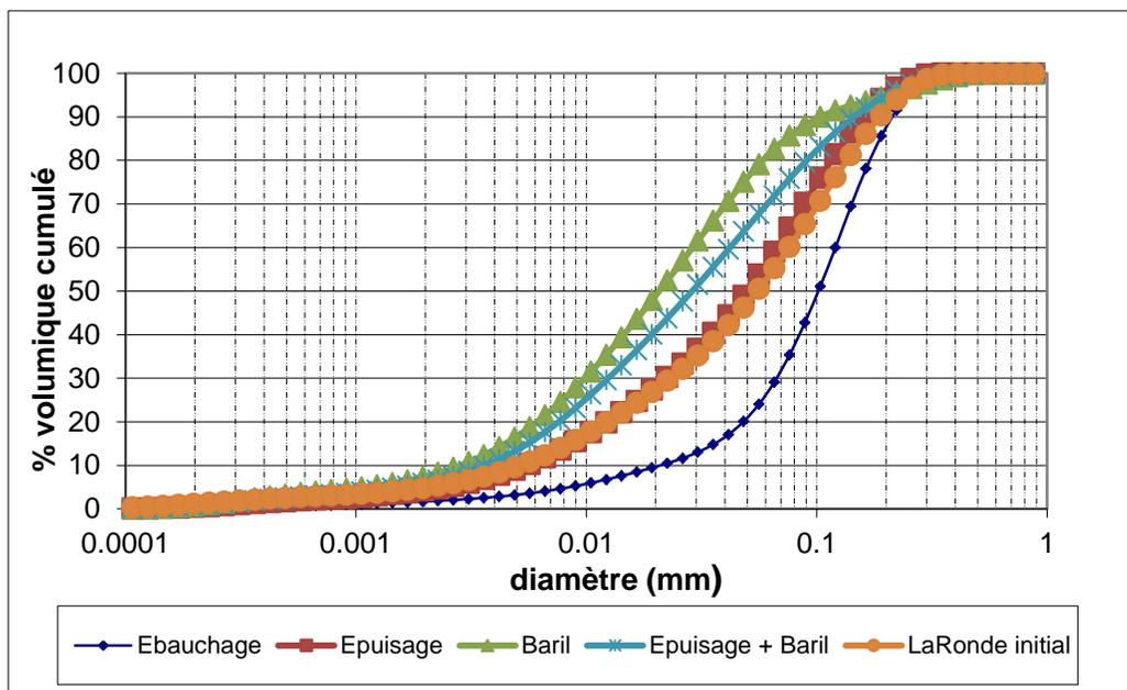
**Figure 3-9 :** Courbes granulométriques des résidus désulfurés
