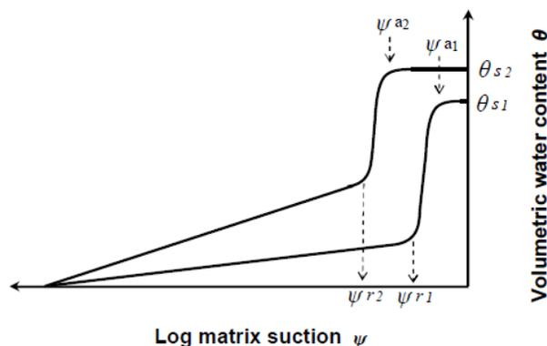
**Figure 2-2** : Schématisation de la CRE (tirée de Aubertin et al., 2009)
