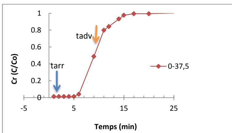
**Figure 3-14:** Courbe d'apparition du traceur stériles Bousquet 0-37,5 mm
