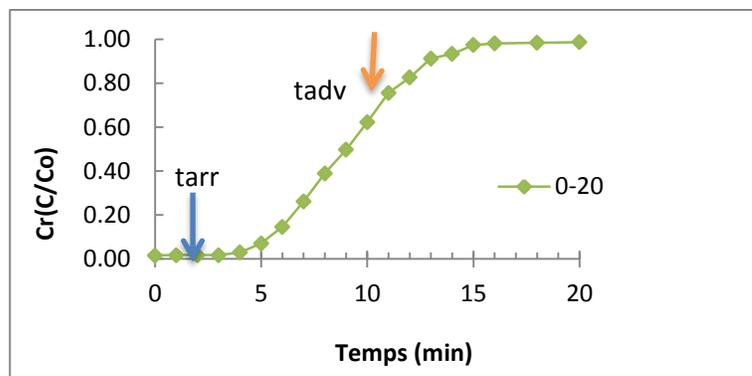
**Figure 3-13 :** Courbe d'apparition du traceur stériles Bousquet 0-20 mm
