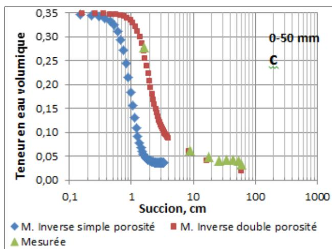
**Figures 3-26** : CRE mesurées et obtenues par modélisations inverses; a) stériles 0-20 mm, b) stériles 0-37,5 mm et c) stériles 0-50 mm
