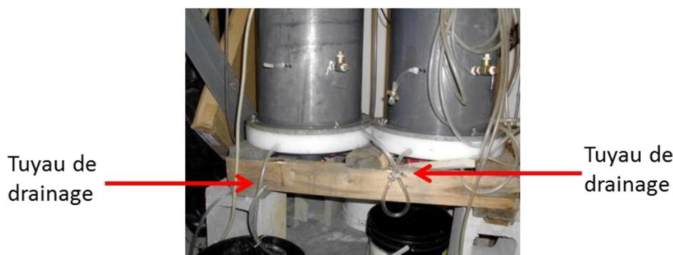
**Figure 3-6** : Drainage des colonnes lors des essais
