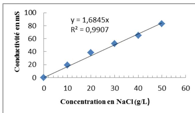
**Figure 3-8** : Droite de calibration du conductimètre
