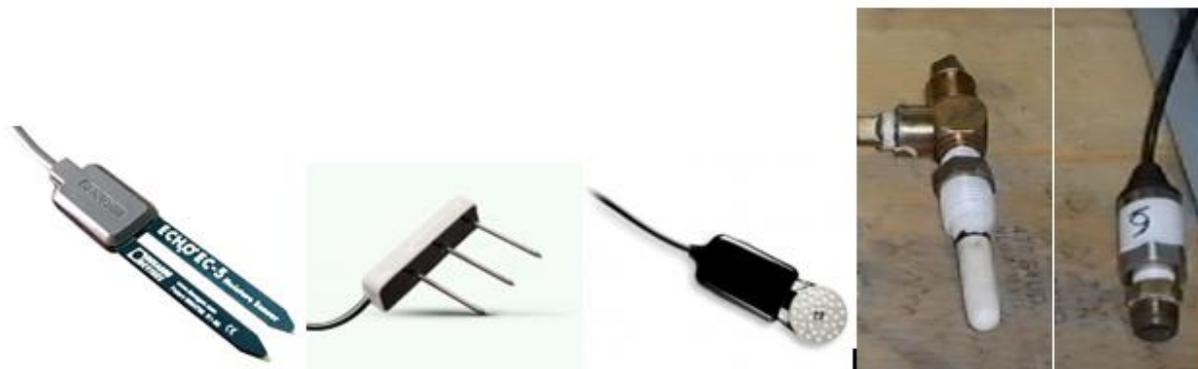
**Figure 3-30** : Images des sondes et senseurs (de gauche à droite) : EC-5, GS-3, MPS-2, Connecteur + bougie poreuse et capteur de pression
