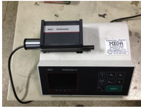
Resim 2.1. MAHR- Perthometer M1 taşınabilir yüzey pürüzlülük cihazı
