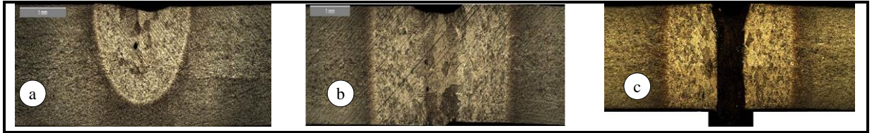
Şekil 3. Lazer kaynağı ile farklı parametrelerle birleştirilen levhaların kesit görüntüsü (x50)
