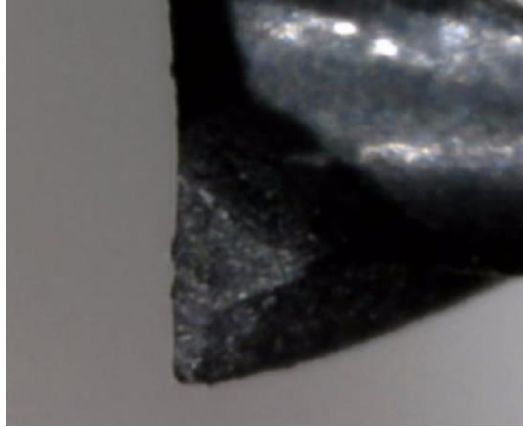
Şekil 2 : Mikro freze takımının kesici ağzının mikroskop görüntüsü
