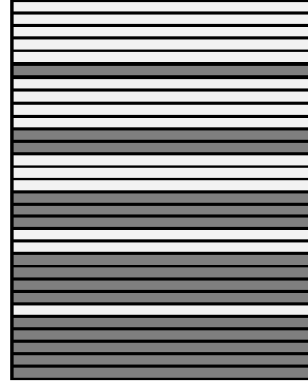
Şekil 2. Fonksiyonel derecelendirilmiş kompozitin tabakalanma sırası (gri renk karbon fiber kumaşları, beyaz renk cam fiber kumaşları temsil etmektedir)
