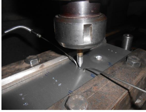
Şekil 1. Deney Düzenğinde kullanılan konik takım, ısıölçer ucu, iş parçası ve bağlama aparatı
