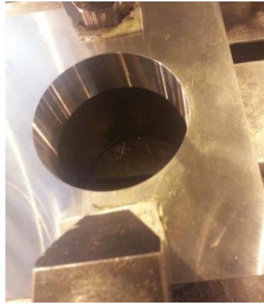
Şekil 1. Test parçasının freze tezgahı tablasına bağlantısı
