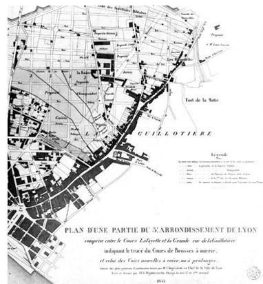
Plan d'une partie du 3ème arrondissement de Lyon ... indiquant le tracé du cours de Broesse à ouvrir et celui des voies nouvelles à créer, ou à prolonger / J.-C.-J. Dignoscyo, 1855. Détail (AC Lyon. 3 S 10 b)
