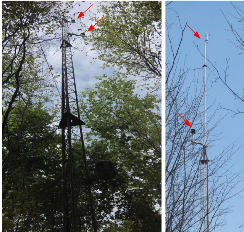
Figure 2.13: Mât muni de 2 anémomètres soniques et d'un anémomètre à coupelles (flèches rouges indiquent la position des anémomètres)
