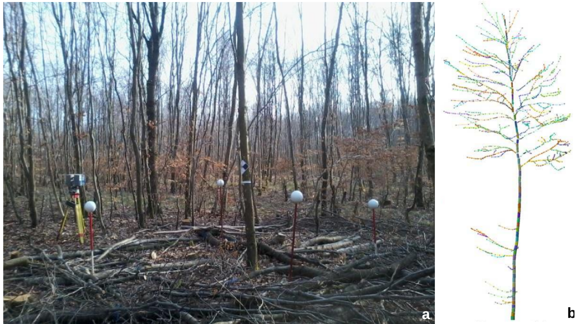
Figure 4.1: Mesure du défilement des tiges au LIDAR terrestre.
