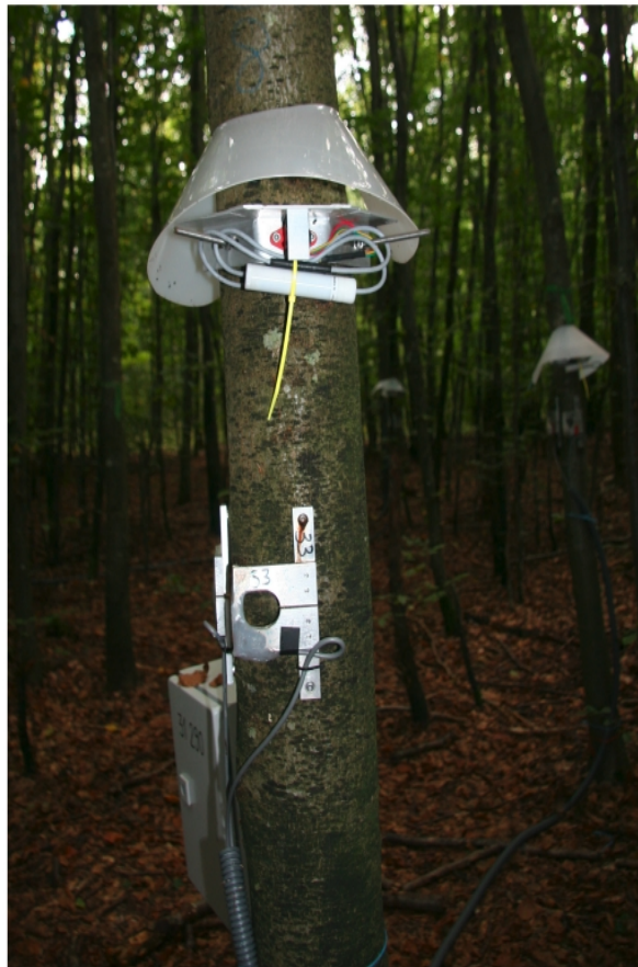
Figure 2.16: Installation des capteurs de déformation et de croissance sur un arbre. Les capteurs de déformations sont vissés à 1m de haut, orthogonaux entre eux. Ils sont reliés par câble au V-link dans le boîtier (non visible) . Au dessus et à 30 cm, d'un des capteurs de déformation, le dendromètre automatique, protégé de la lumière par un chapeau blanc. On devine au fond à droite l'arbre apparié relié au même V-link.
