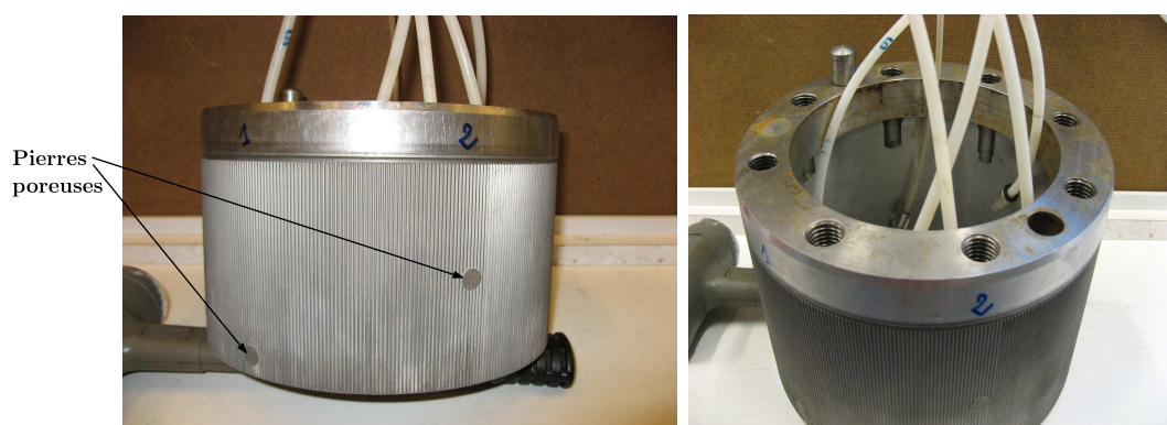
FIGURE 1.9 – Photos du Clou Perméabilité muni de 6 pierres poreuses (diamètre 10 mm, épaisseur 2 mm) disposées sur deux niveaux, 3 par niveau espacées de 120^\circ . D’un niveau à un autre les pierres sont espacées de 60^\circ . La photo de droite laisse apparaître les coudes vissés sur la surface intérieure du clou pour le raccordement des tubes. On remarque que les pierres et les tubes sont numérotés. Ces numéros sont reportés sur le manchon de fixation qui se positionne sur le dessus du clou, ceci permet le repérage des pierres lors de la rotation du clou.
