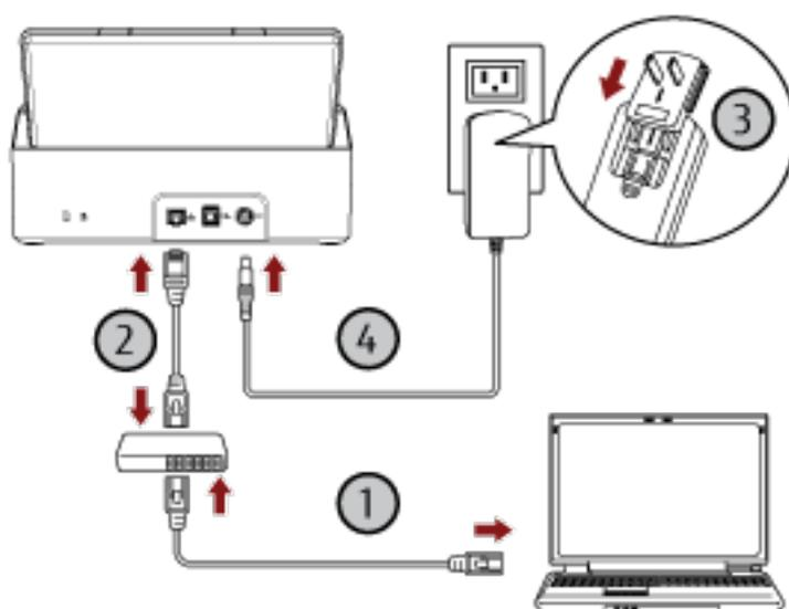
a Connectez l'ordinateur à un périphérique réseau via un réseau LAN câblé ou un réseau Wi-Fi (1).
