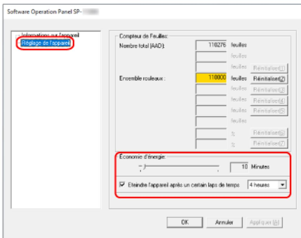
**3 Configurez le délai avant le passage du scanner en mode économie d'énergie.**
