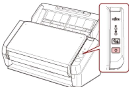
Après que l'indicateur de mise sous tension clignote pendant quelques instants, le scanneur se met hors tension et l'indicateur de mise sous tension s'éteint.
