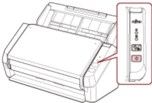
Le scanner se met sous tension et l'indicateur de mise sous tension clignote en vert pendant l'initialisation. Lorsque l'indicateur de mise sous tension s'allume en vert, le scanner est prêt à numériser. Cet état est appelé l'état "Prêt".
