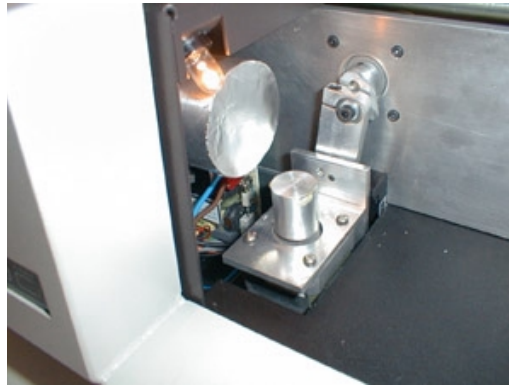
Figure III.21 : Base du support de l'objet permettant la rotation et le déplacement vertical (Skyscan, 2000).
