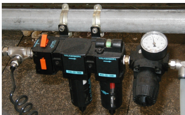
Figure III.7 : Bloc de filtration-régulation de pression de l'air (Wilkerson).
