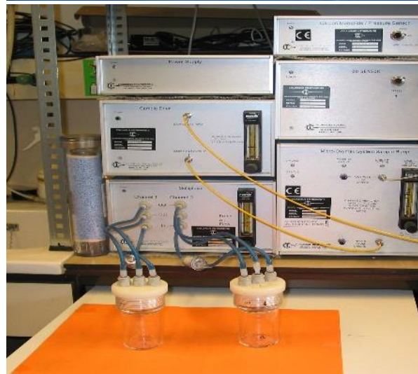
Figure 25: Carbon monoxide uptake monitor®. Appareillage tel que conçu par Columbus Ins. et la mise en place des souris (La première image est issue du site web de Columbus Ins®).
