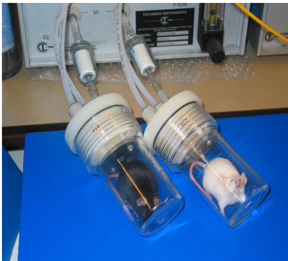
Figure 25: Carbon monoxide uptake monitor®. Appareillage tel que conçu par Columbus Ins. et la mise en place des souris (La première image est issue du site web de Columbus Ins®).
