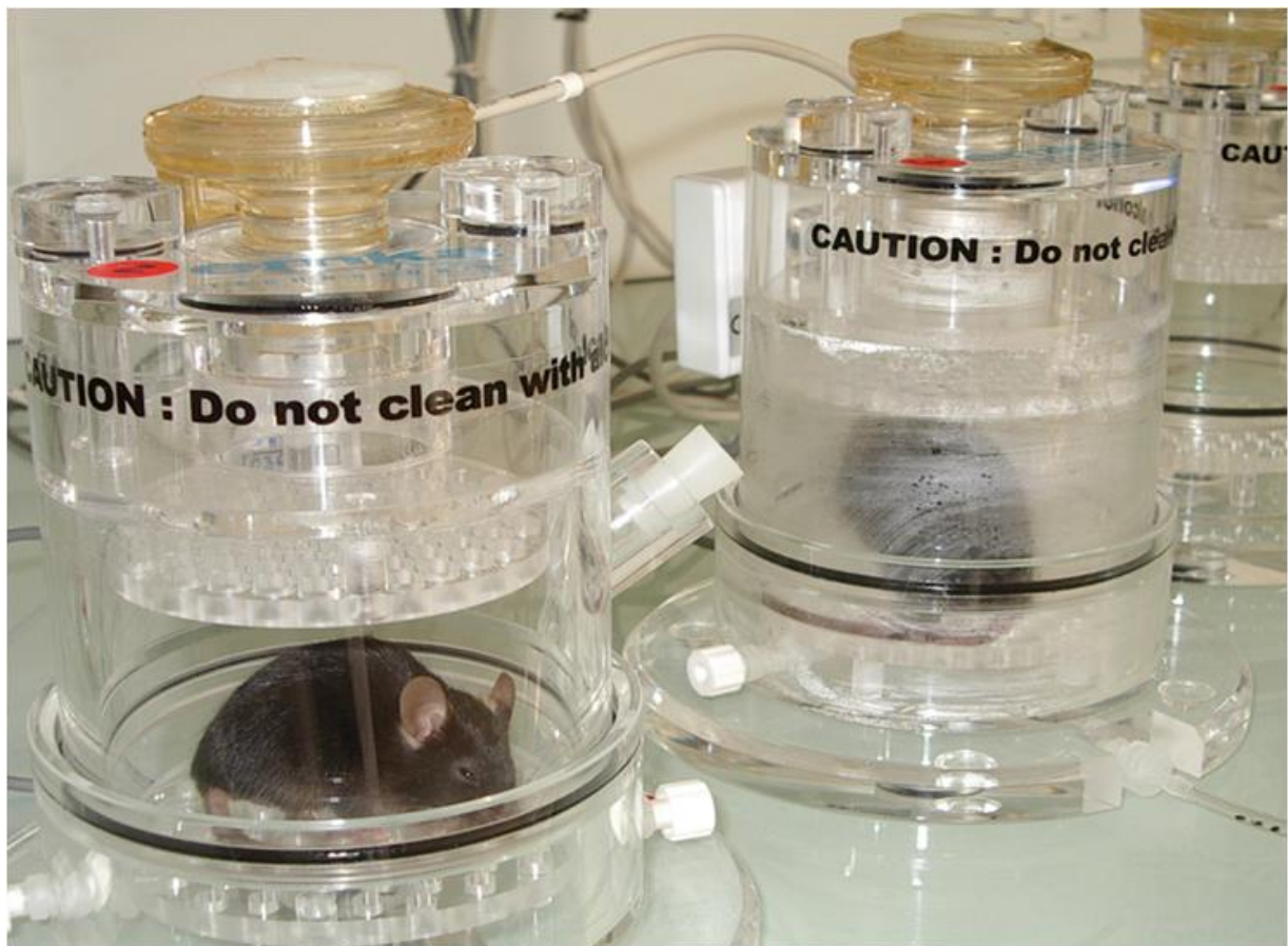
Figure 14: Photo de pléthysmographe barométrique en chambre simple pour souris. On observe les souris en position pour la mesure. Source : site web de Therassay®.
