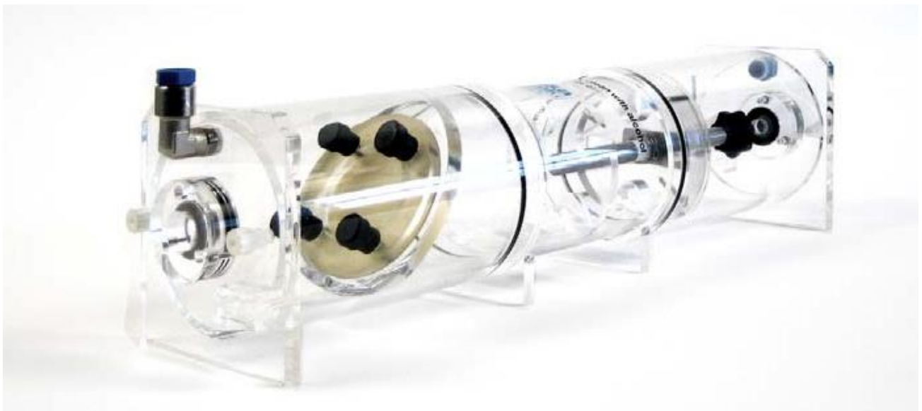
Figure 15: Chambres nasale et thoracique du pléthysmographe barométrique en chambre double. On peut observer, au milieu, le joint en silicone nécessaire pour assurer l'étanchéité entre les deux chambres (Source EMKA®).
