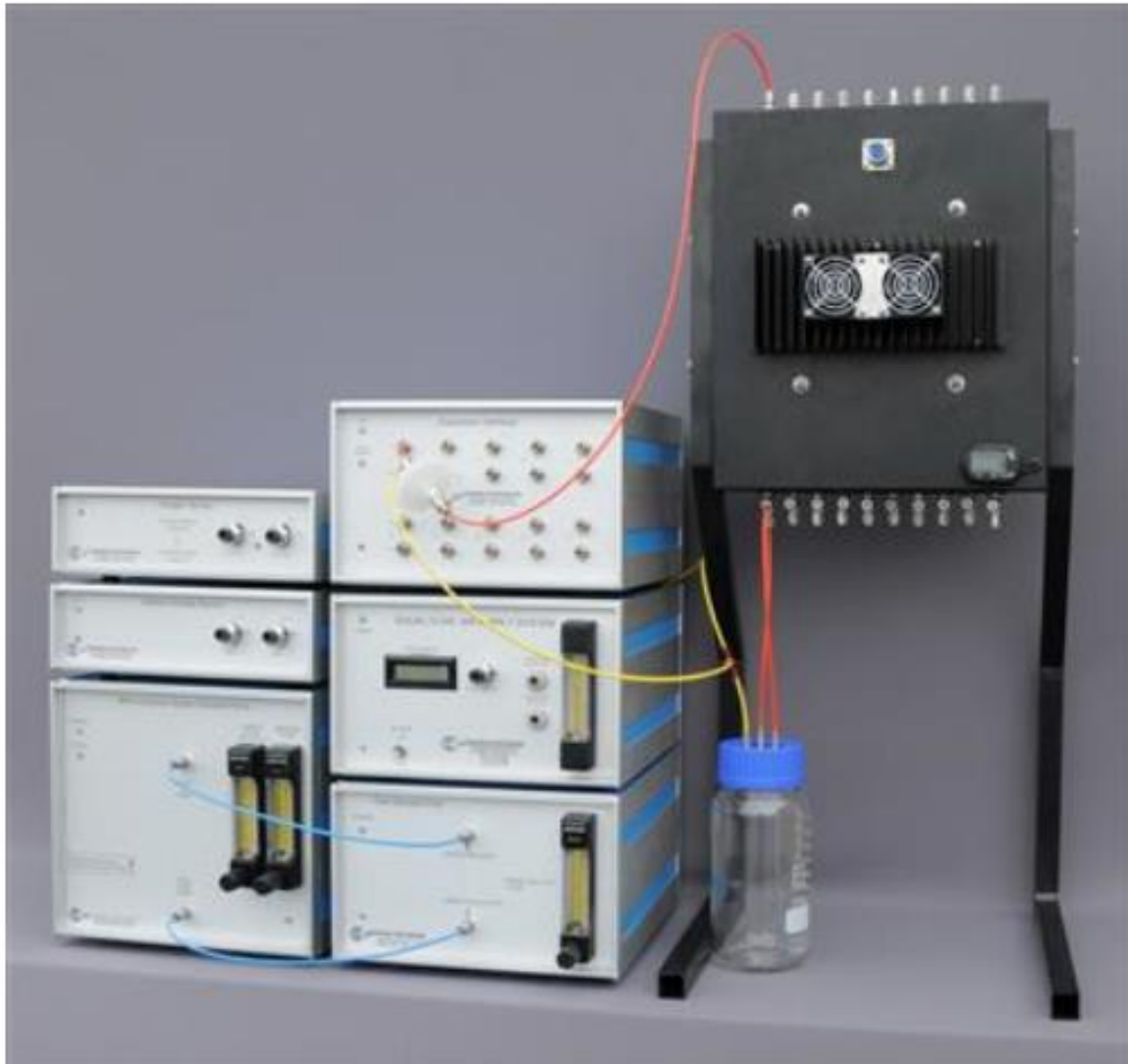
Figure 44 : Micro-Oxymax respirometer ® développé par Columbus Instruments®, candidat potentiel de remplacement du CO uptake monitor ®. Le système Micro-Oxymax ® de Columbus Instruments® est décrit comme un « respiromètre » en circuit fermé. Le système mesure en permanence la concentration des gaz contenus dans un espace fermé dans lequel l'animal éveillé respire. La détection périodique de la concentration de chaque gaz (plusieurs gaz sont possibles), associée à une mesure du volume de cet espace, permet de calculer les valeurs incrémentielles et accumulées liées à la consommation ou la production de ces gaz. Le système peut être configuré pour 6 gaz (l'oxygène, le dioxyde de carbone, le méthane, le monoxyde de carbone, le sulfure d'hydrogène et l'hydrogène) et surveiller jusqu'à 80 chambres séparément. Source: Site interne de Columbus Ins®.
