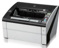
Les impressionnantes vitesses de numérisation font du fi-6800 un appareil à part. A une résolution de 300 dpi en mode paysage A4, il peut numériser 130 pages par minute, en mono ou en couleur. Il double sa production à 260 images par minute en duplex. Le chargeur automatique accepte un maximum de 500 feuilles.
