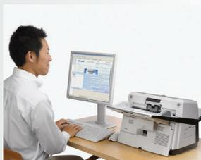
A une résolution de 300 dpi, ces vitesses sont de 160 ipm et de 80 ppm, de plus tous les modèles numérisent jusqu'à une résolution de 600 dpi. Les lots de numération mixtes vont du format A8 au format A3 (même les documents en forme de trapèze peuvent être numérisés entièrement, la qualité et le grammage de la feuille va de 31 g/m<sup>2</sup> à 209 g/m<sup>2</sup>).
