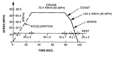
NOTE THE SHAPE OF THE ACCELERATION PORTION OF THE DUTY CYCLE CURVE IS UNDEFINED
