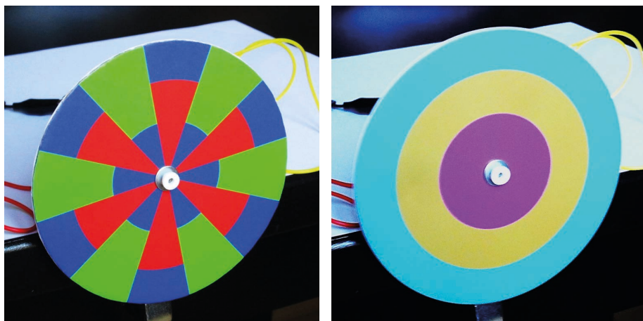
Figure 6 - Disque de Maxwell avec des secteurs rouge, vert et bleu, à l'arrêt (à gauche) et en rotation (à droite).
