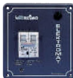
**Einbaugeschäule mit FI-Schutzschalter** Der 2-polig schaltende Automat (13 A) sichert vor Überlast, Kurzschluss und elektrischen Unfällen. Netzabschaltung erfolgt bei Fehlstrom von 30 mA. TÜV-/GS-geprüft. Gehäuse: Alufontplatte, Grau, Ausstattung: Leuchtanzeige für Betriebsbereitschaft, Klemmschiene für Schutzleiter und Potentialausgleich mit Zugentlastung. Maße: B 130 x H 140 x T 60 mm. Einbauöffnung L106 x B115 mm
