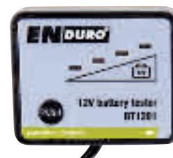
**Batterietester BT1201 Enduro** 12V, schwarz/grau: für den festen Einbau im Wohnwagen, Wohnmobil oder Boot direkt an der Batterie: ideal für Versorgungsbatterien oder Batterien in Fahrzeugen mit langer Standzeit. Spannungsbereich: 8-16 Volt, Stromverbrauch: max. 70 mA, Batteriesorten: Blei-Säure, AGM, Gel. Farbe: schwarz/grau, Produktmaß: ca. L 60 x B 50 x H 20 mm
