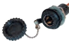
Wasserdichte DIN-Einbau-Normsteckdose mit Schraubdeckel 12-24V. Einbauöffnung: 18,4 mm. Temperaturbeständig: -40°C bis 105°C. 16A
