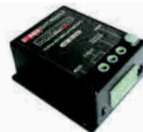
**Automatischer Batterieschalter 12 Volt (Tiefentladeschutz)** Der BS 12/100 trennt die Batterie bei Unterschreitung von 11 Volt und schaltet automatisch wieder frei, sobald die Spannung wieder über diesem Wert liegt (z.B. bei Ladung). Ein Schalter ermöglicht die manuelle Einschaltung der Batterie, nachdem die Abschaltung erfolgte. Spitzenlast bis 100A. Zustandsanzeige mit LEDs.
