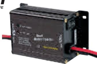
**Carbest Batteriewächter** Erhöhen die Lebensdauer der Batterie, trennt Verbraucher automatisch, wenn die Spannung unter 10,5 V bzw. 21 V absinkt. Verbindet autom. wenn 12 V/24 V wieder erreicht sind. Überlast-/kurzschluss- und verpolungssicher. Mit Schalter, 2 Kontroll-LEDs. Alu-Gehäuse.
