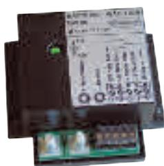
**Batteriewächter BW 50** Batteriewächter speziell für die Verbraucher, die viel Strom benötigen, wie z. B. Klimaanlage. Die Abschaltspannung liegt bei 11,3V, Einschaltspannung 11,9V. Maße: L 100 x B 90 x H 43 mm, Gewicht 140 g. Schaltleistung max. 50A.
