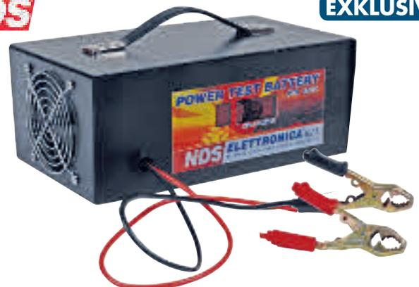
Gibt eine präzise Auskunft über den tatsächlichen Energiegehalt einer Batterie. Lädt Batterien mit genau 10 A Strom, bis die Entladespannung von 10,5V erreicht ist und misst die dabei verstrichene Zeit in Minuten (d.h. 6 Minuten Anzeige entsprechen einer Amperestunde). Kapazitätsermittlung anhand Vergleichstabelle.
