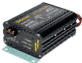
**Wandler IPC 21-20** 24V auf 12V-20A Schutz gegen Überlastung, Überhitzung und Kurzschluss. Wirkungsgrad 90%, Aluminium-Gehäuse, Ausgangsstrom 20A, Eingangsspannung 20-32V Ausgangsspannung 13,8V, Betriebstemperatur -20°C bis 50°C. Maße 200 x 115 x 80 mm Gewicht 1,0 kg
