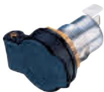
DIN-Einbau-Normsteckdose 12-24V 16A mit Metallgehäuse, Einbauöffnung 18 mm, Innen-Ø 12 mm, Flachsteckeranschlüsse 6,3 mm.
