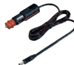
Universalstecker 8 A mit 2 m Kabel 2 x 0,75 mm<sup>2</sup> und Hohlgerätestecker 2,5 x 5,5 mm.
