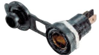
Mit Deckel und Flachsteckeranschluss 6,3 mm, max. 16A / 12-24V, TÜV-geprüft und -überwacht, nach DIN EN ISO 4165. Einbauöffnung 18 mm. 16A
