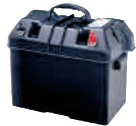
**Batteriekasten mit Aussenklemmen, 2x 12V Dose und Testfunktion** 2x M10 Flügelschraube, 2x 12V Dose und Batterietester im Deckel, schwarz, Aussenmaß: L 42x B 23x H 31 cm, Innenmaß L 34, 29x B 19, 4x H 22 cm.
