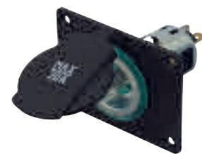
Powersteckdose 12-24 V mit Montageplatte zum Fronteinbau. 20 A bei einem Kabel-Ø von 2,5 mm<sup>2</sup>, 15 A bei Kabel-Ø von 1,5 mm<sup>2</sup>. Innen Ø 21 mm, Einbauöffnung 27,8 mm. L60 x B45 mm
