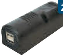
12 / 24V DC / 5V DC, USB: 2 x 2,5A mit integriertem Spannungswandler. Kabelanschluss ca. 150 mm vor-konfektioniert. Abmessungen LxBxH: 85x35x33 mm.
