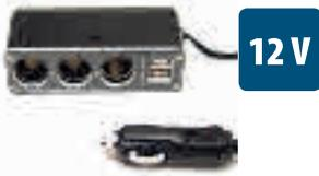
3-fach Verteiler mit 2 USB-Anschlüssen, 5V, starke 2,1A. 20cm Spiralkabel, ausziehbar bis ca. 1m. Ideal zum Laden von Handys. Max. 5A, mit Sicherung, LED Betriebsanzeige an Stecker und Gehäuse (rot).
