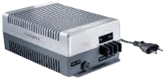
**IUOU-Automatiklader, 12 Volt** Optimale Ladetechnik für 12 Volt Nass-, Gel- und Vliesbatterien. Laden von 1 Batterie, Eingangsspannung: 230V DC. Eingangsspannungsbereich: 180 – 253V AC/50 – 60 Hz Batterie-Nennspannung: 12V DC, Schlussspannung: 14,4V DC Erhaltungsladespannung: 13,6V DC, max. Batteriekapazität: 100Ah. Max. Ladestrom: 8 A, Betriebstemperatur: 0 °C bis +50 °C
