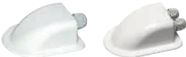
Zur sicheren Kabelführung durch Dächer oder Wände. Klein, kompakt, wasserdicht. Zum Aufkleben mit Sikaflex inkl. PG 13,5 Kabelverschraubung für Kabel Ø 6-12 mm.
