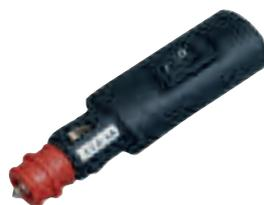
Winkelbarer Sicherheits-Universalstecker 8 A mit EIN/AUS Schalter. Der Stecker ist durch 180° Schwenkbarkeit abgewinkelt damit das Kabel nach unten abgeführt wird. Passend in Zigarettenzünder- und Normsteckdosen. Kabelanschluss durch Lötkontakte
