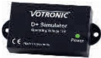
**D+ Simulator** Kein mühsames Suchen der D+ Klemme an der Lichtmaschine mehr. Der D+ Detektor erkennt automatisch den Ladevorgang der Lichtmaschine und erzeugt ein Steuersignal, welches zum Ansteuern eines Trennrelais oder diverser Zusatzverbraucher verwendet wird. Ausgang: 12V/1A. Maße: 70 x 36 x 17 mm. Nicht für Fahrzeuge mit Euro6-Norm geeignet!
