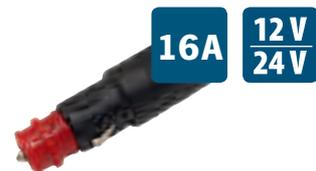
Universalstecker mit zwangsgeführter Zugentlastung. 16A/12-24V. Mit Schraubkontakten bis 2,5mm<sup>2</sup>, (wie 81012, jedoch als 16A).
