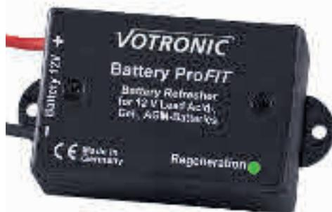
**Battery ProFIT 12V** Sorgt für Fitness der Batterie während der Fahrt und bei der Ladung. Schickt kräftige zusätzliche Ladestromimpulse (ca. 8.000/Sek.) an die Batterie und baut so vorhandene Sulfatlagerungen ab. Bei nicht zu starker Vorschädigung der Batterie kann die Kapazität wieder die alten Werte erreichen. Stromaufnahme nur 0,1A. Maße: 76 x 40 x 25 mm, Gewicht: 80g.
