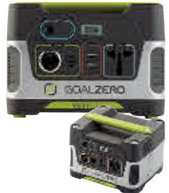
**YETI 150** Solar Powerspeicher 14.000mAh, AGM Powerpack, Ausgänge: -12V/120W, -230V/80W über Inverter -2xUSB 5V/2,1A (max. 10,5W). Ladung über Lade-Port 14 bis 29V. Maße: 195x146x172mm. Gewicht: 5,4kg.
