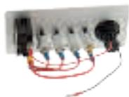
**Reimo Checkpanel 713, Abschalten der 12V Anlage.** 4 abgesicherte Ausgänge (Sicherungsautomat 1 x 12 A/3 x 10 A). Zentrale 12V-Verteilung vom Panel. Integrierte Normsteckdose 12V/16A\*, Ein-/Aus-Hauptschalter 12V/20A (Hauptschalter ist gleichzeitig 20A Sicherung). Maße: H:72 x B: 155 x T: max. 95 mm. \*(Wird die Steckdose über 10A belastet, muss sie über eine extra Leitung separat abgesichert werden, bis 16A maximal!)
