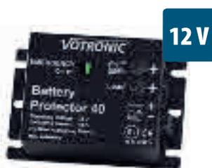
**Batteriewächter Protector 40A** Wird zwischen 2. Batterie und Verbraucher geschaltet. Abschaltung bei 10,7V, EIN bei 12,5V. Eigenverbrauch nur 2 mA. Schaltleistung 12V/40A, kurzzeitig 30% überlastbar. Fernbedienbar, mit NOT-EIN-Funktion. Maße: 90 x 60 x 38 mm, Gewicht: 97 g. Mit Not-Einschalter.
