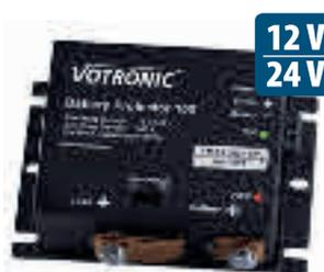
**Batteriewächter Protector 100A** Zum Schutz der Bordbatterie vor Tiefentladung. Als Batterie-Hauptschalter mit 1-pol. Schalter fernbedienbar möglich. Mit Not-Ein Funktion. Abschaltsschwellen einstellbar. Durch Voralarm können frühzeitig Gegenmaßnahmen ergriffen werden. Mit Kontroll-LED, Schaltstrom 100A, kurzzeitig bis 180A. Maße: 105 x 70 x 37 mm, Gewicht: 180 g. 12V/24V umschaltbar.
