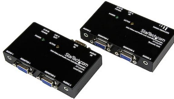
El Extensor de Señal de vídeo VGA a través de Cat5 con Audio (ST122UTPAEU) permite conectar 4 monitores (2 locales y 2 remotos) a una PC. La señal de vídeo y la correspondiente señal de audio son enviadas a través de un cable UTP estándar Categoría 5 o superior de 4 pares (se recomienda Cat 5e), admitiendo distancias de hasta 150m / 500 pies.
