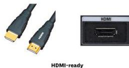
Устройство HDMI Ready обладает всем необходимым аппаратным обеспечением для работы через мультимедийный интерфейс высокой четкости (HDMI). С помощью одного HDMI-кабеля цифровой видео- и аудиоконтент высокого качества передается с ПК или с любого количества аудио- и видеоисточников (включая телеприставки, проигрыватели DVD, ресиверы A/B и видеокамеры).
