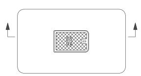
HINGED CAST IRON READER DOOR (FOR METER BOXES, WATER, GAS, ETC.)
