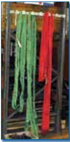
Correcte opslag van stropen.
