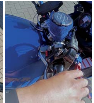
Rechts: Daumenbremse, Blinker, Hupe, Kupplung
