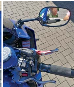
Rechts: Daumenbremse, Blinker, Hupe, Kupplung
