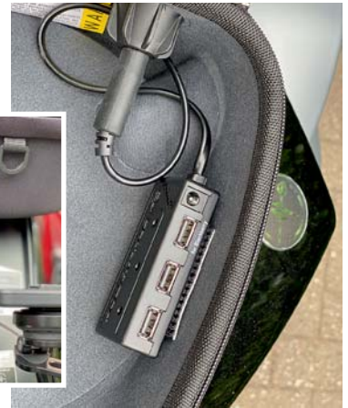
USB-Power-Hub S111 mit regen-fester Kabeldurchführung.
