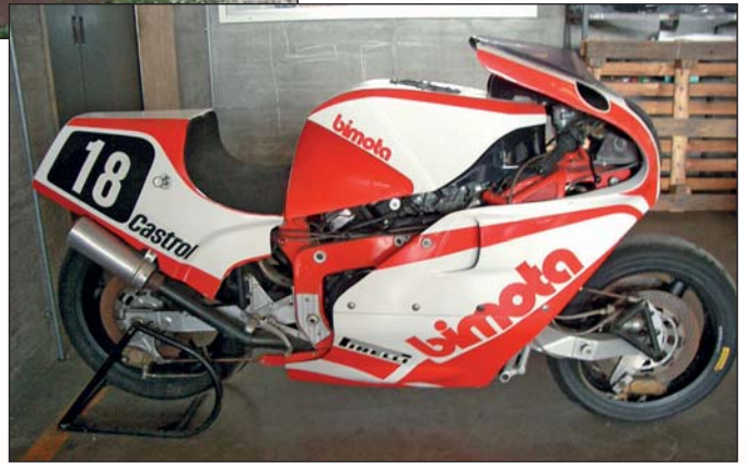
Der zweite Prototyp mit einer komplett anderen Rahmenkonstruktion und zwei Bremsscheiben im Vorderrad.
