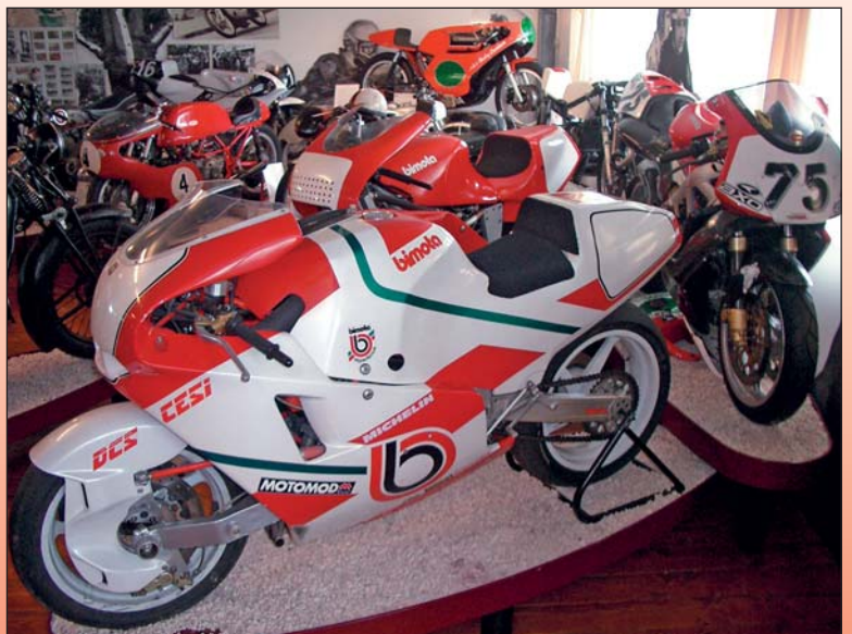
In der Tesi 4 verbaute Bimota einen Yamaha-Reihenmotor und erstmals eine mechanische Lenkung.
