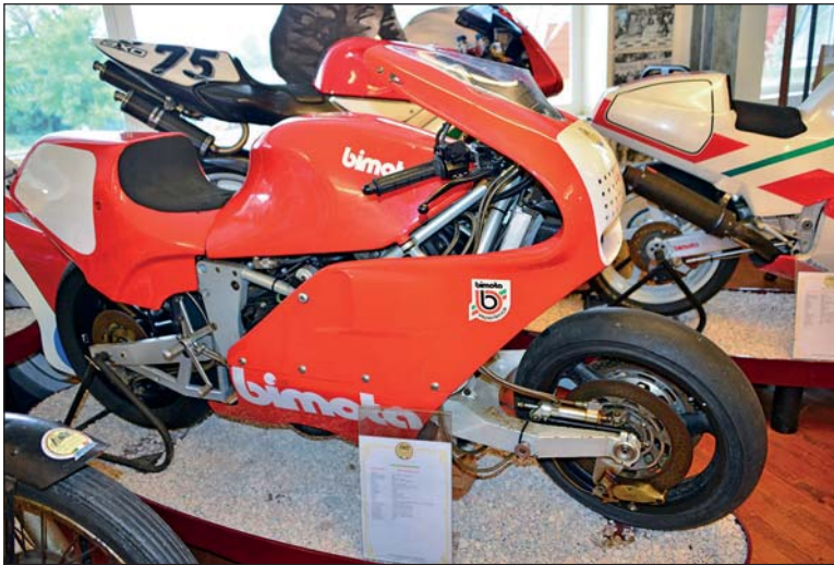
Tesi Nummer drei, noch mit Honda-V4-Motor aber mit Aluminiumrahmen.
