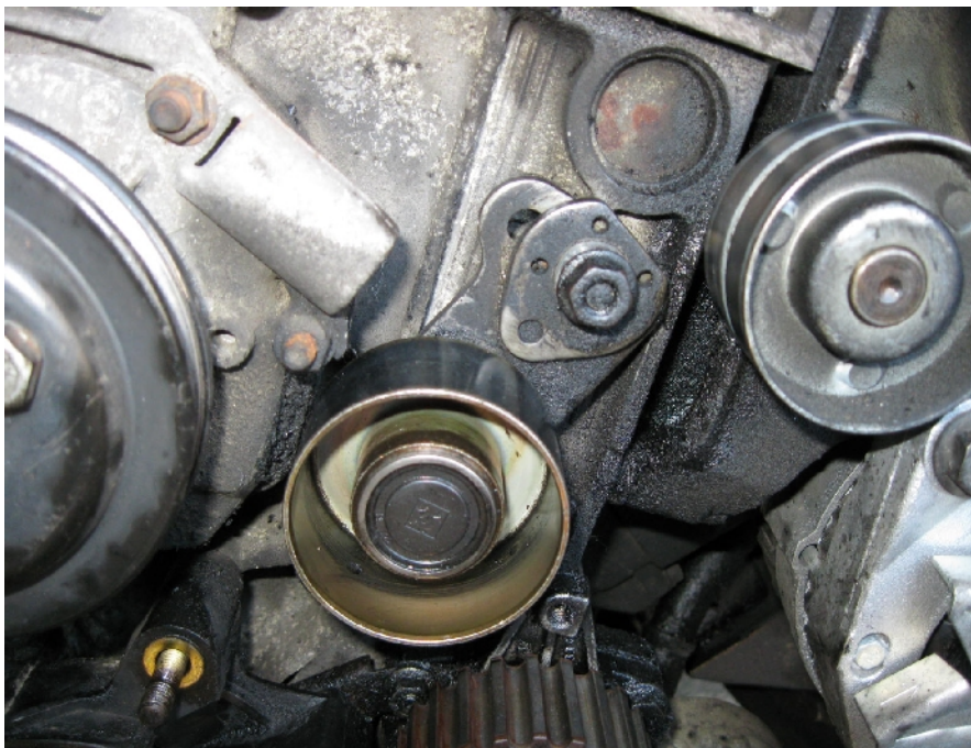
Photo trouvée sur internet sur laquelle on voit l'ancien modèle de tendeur avec son ressort prenant appui sur le corps de la pompe à eau.
