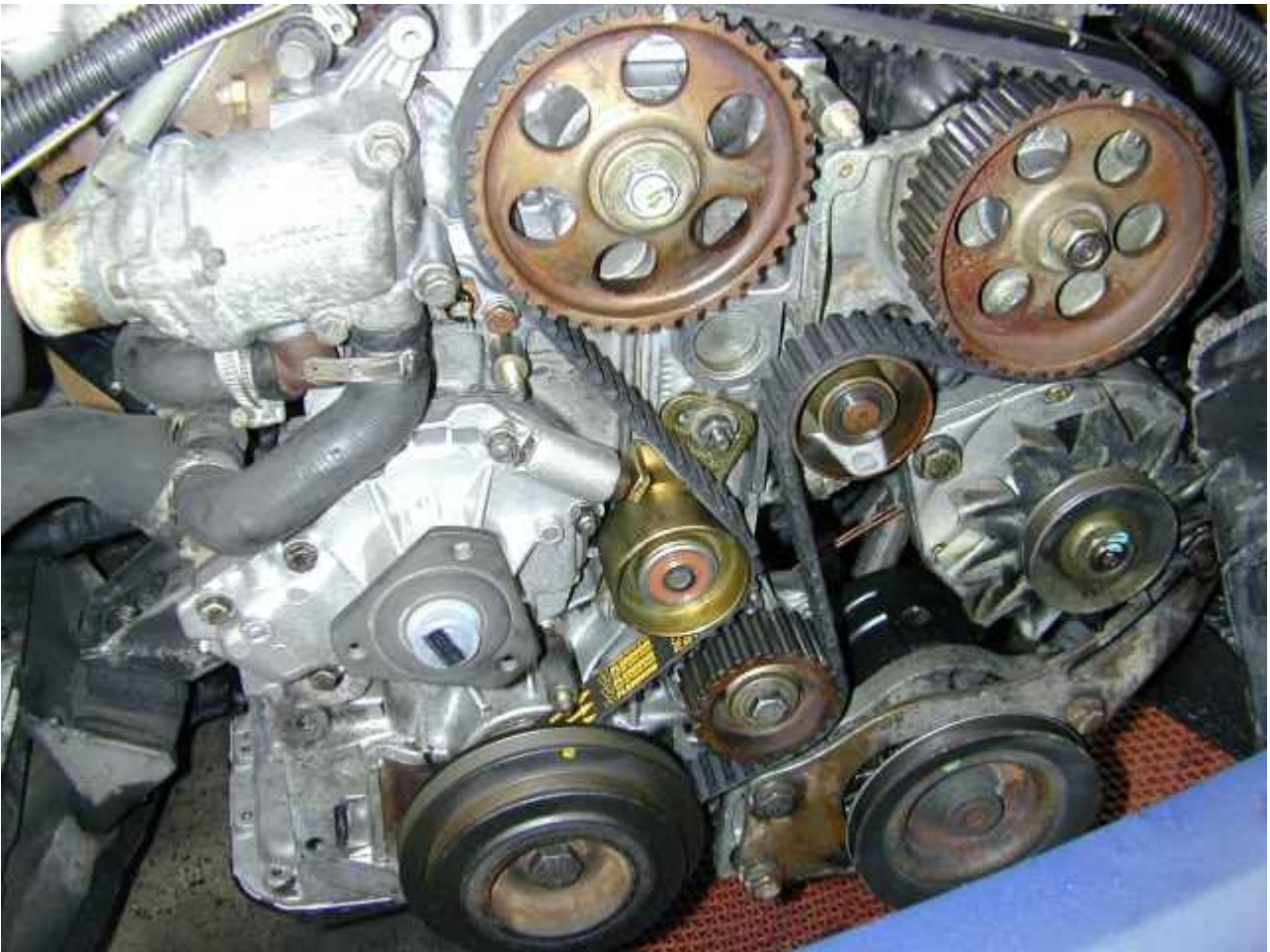
Photo trouvée sur internet sur laquelle on voit l'ancien modèle de tendeur avec son ressort prenant appui sur le corps de la pompe à eau.
