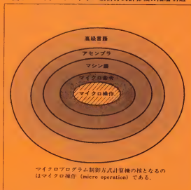
図3 マイクロプログラム制御方式計算機の階層構造
