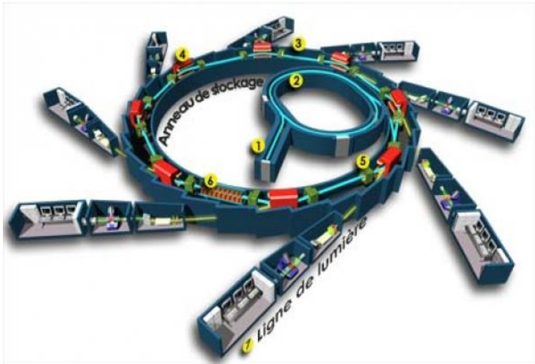
Figure II.4. Schéma de principe du synchrotron SOLEIL : (1) : l'accélérateur linéaire, (2) : l'accélérateur circulaire ou Booster, (3) : l'anneau de stockage, (4) : aimants de courbure et onduleurs, (5) : cavité radiofréquence, (6) : émission de rayonnement de freinage et (7) : ligne de lumière [Sol].
