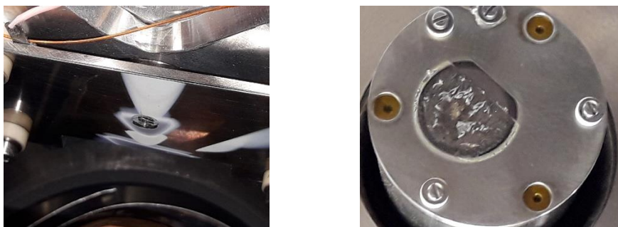
Figure II.11. Photos des dépôts de lithium après utilisation du four.
