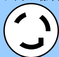
P9R48A の 入力電源プラグ形状 ツイストロック コネクター 単相 100V 30A 【NEMA L5-30P】
