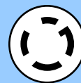
P9R58A の 入力電源プラグ形状 ツイストロック コネクター 三相 200V 30A 【NEMA L15-30P】
