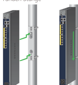
Switch-Befestigung an einer runden Stange
