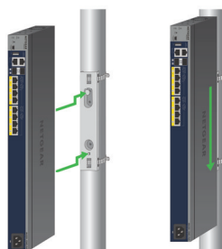
Switch-Befestigung an einer runden Stange
