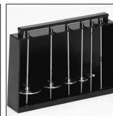
Support et tiges standard R2, R3, R4, R5, R6 et R7 pour modèle R.
