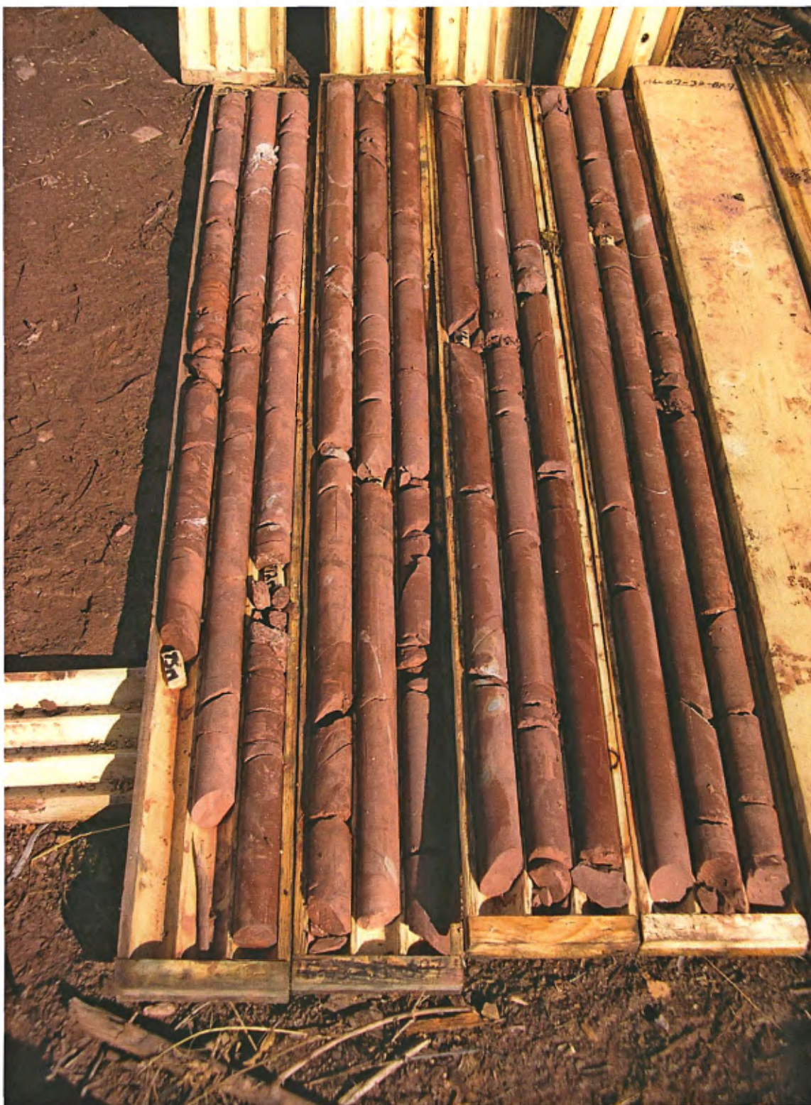
Photo 3: Claystone rouge d'aspect massif, recoupé en profondeur Sondage no 05, 57 à 75 mètres.
