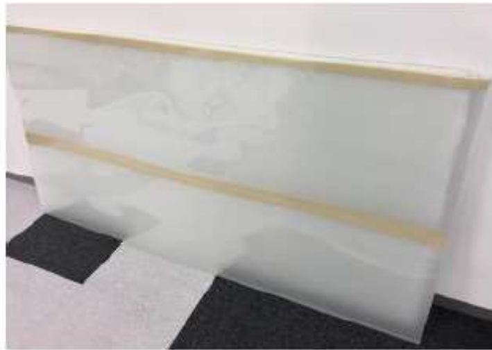
図 3.3.69 反射シートをプラスチック段ボールに貼り付けた状態のイメージ
