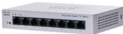
図 2.3.44 各機器接続用スイッチ外観
