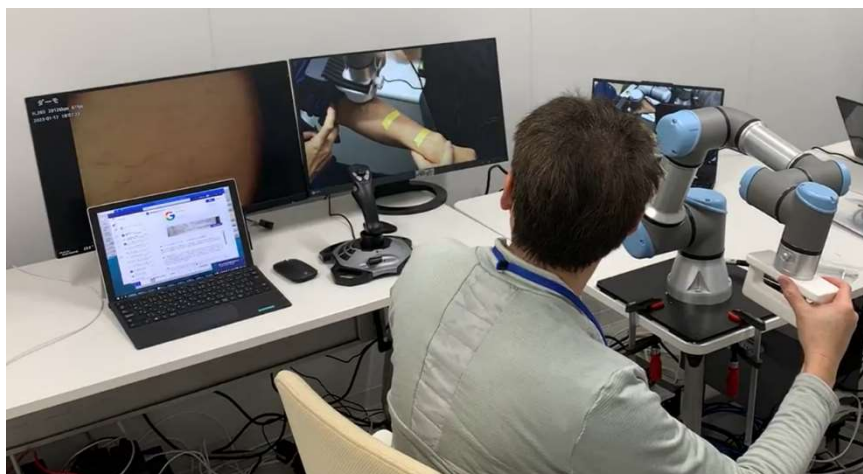
図 4.3.6 課題実証における 8K カメラとダーモカメラを用いたロボット操作の機能検証の様子 1
