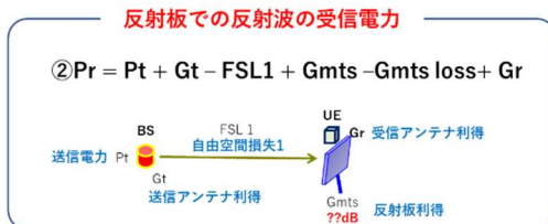
図 3.3.126 回線設計における反射板利得の考え方
