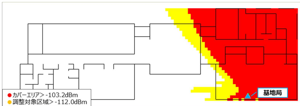
図 3.3.56 エリア算出式によるカバーエリアおよび調整対象区域図(反射板なし、受信アンテナ利得 20dBi)
