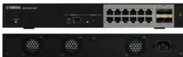
図 2.3.28 各機器接続用スイッチ外観
