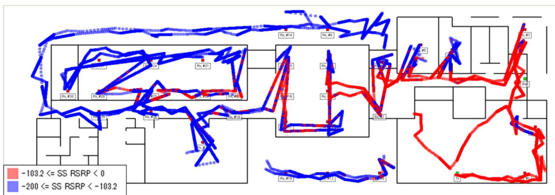
図 3.3.77 歩行測定によるヒートマップ結果(反射板あり)
