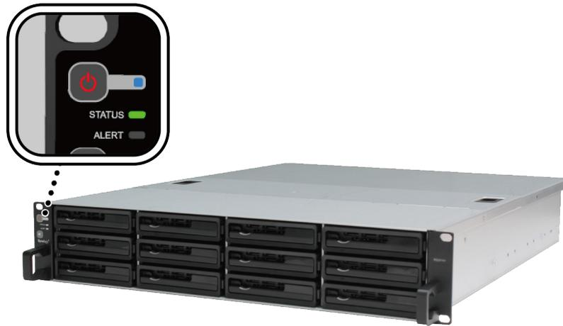
Votre RackStation est maintenant en ligne et peut être détecté par un ordinateur du réseau.
