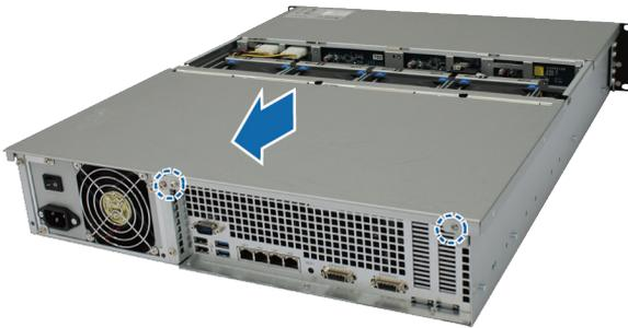
c Retirez les vis du support de fixation et retirez le support de fixation pour découvrir les emplacements de RAM.
