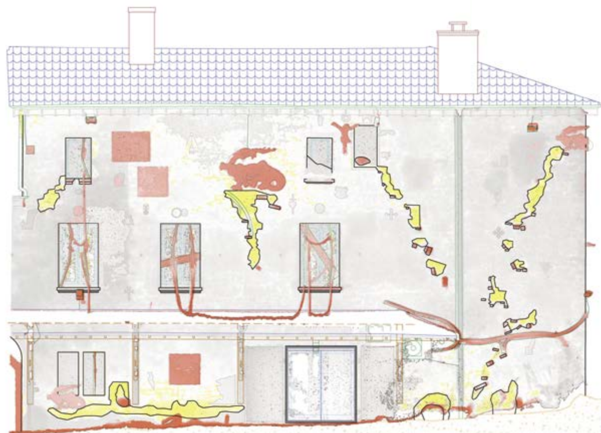
FIG. 2.20 Demeure du Chaos, façade Nord, détail relevé avec analyse existant / addition / soustraction (relevé TTGE, 2020)
