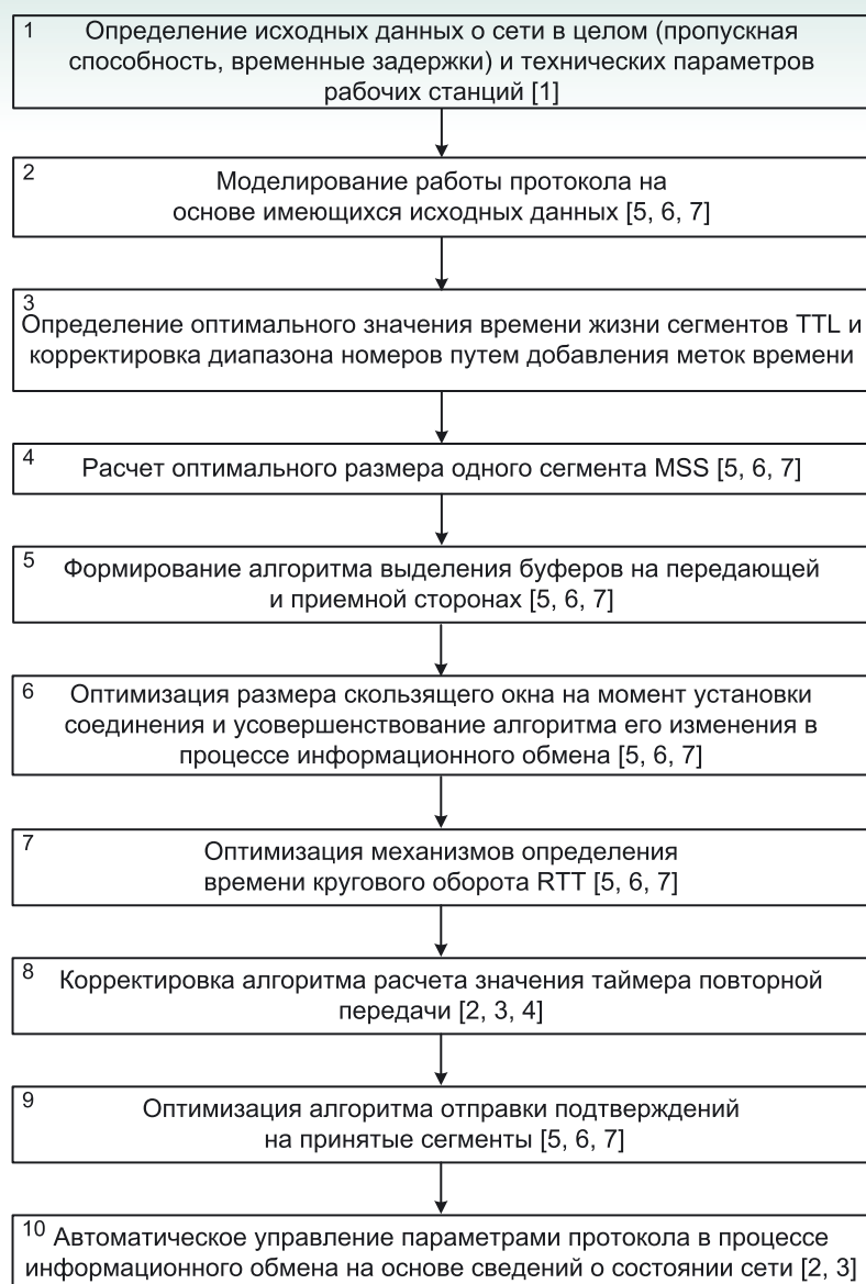
Рис. 1. Методика повышения оперативности информационного обмена абонентов с TCP протоколом в высокоскоростных MPLS сетях
