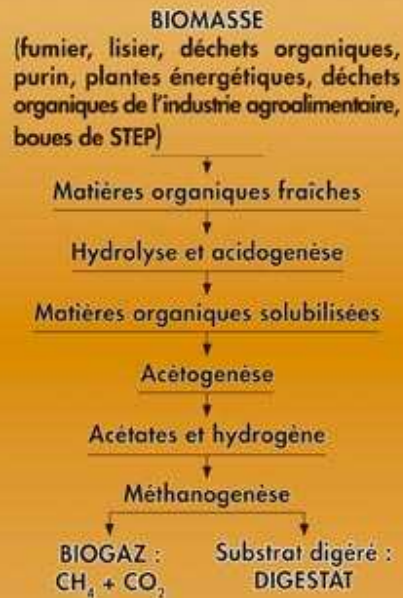
Figure 3 : description des diverses phases de la digestion anaérobie
