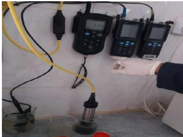
**Figure II.6 :** Multi-paramètre (PH ,O<sub>2</sub>,T ,La conductivité , salinité).
