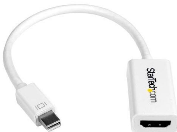
L'adaptateur Mini DisplayPort vers HDMI MDP2HD4KSW vous permet de connecter un ordinateur équipé d'un connecteur Mini DP, comme les MacBook® Pro et MacBook® Air, à un écran HDMI. Cet adaptateur est compatible avec le Mini DisplayPort 1.2 et HDMI 4K à 30 Hz et, par conséquent, peut prendre en charge les résolutions vidéo Ultra HD (4K), ainsi que l'accompagnement audio numérique jusqu'au son surround à 7.1 canaux.
