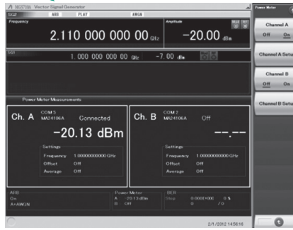
Power Meter Function
