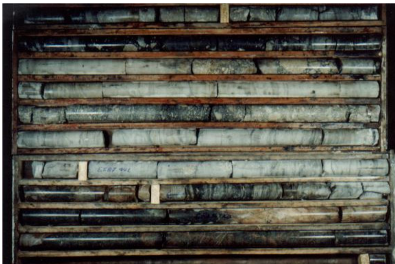
Figura 14: Embasamento cristalino no alto vale do Rio Mãe Luzia. Na base, granito porfiróide de cor rósea a verde-escuro. Na porção superior, conglomerados e diamictitos da Formação Rio do Sul. Testemunho de sondagem do furo PTR-03, Treviso, SC.
