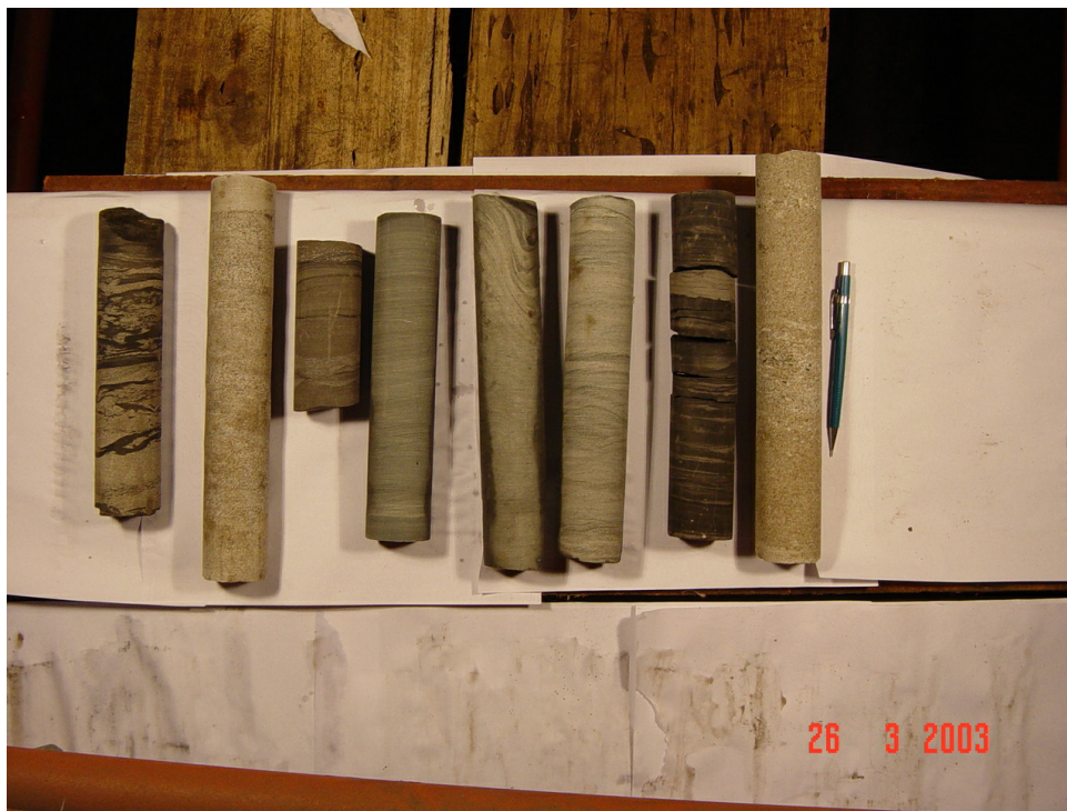
Figura 18: Arenitos fluidizados com estruturas de carga e escorregamento e siltitos com estruturas convolutas. Testemunhos da sondagem PTR-03. Local Rio Ferreira, nas proximidades da cidade de Treviso.
