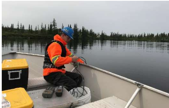
Photo 3.11 Suivi mensuel de la température et de la conductivité à la station AQR69 - bassin nord du lac Lagopède (juin 2018)
