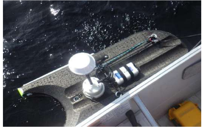
Photo 3.9 Profileur à technologie Doppler
