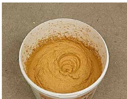
Après 30 minutes, malaxer vigoureusement. La photo montre la consistance prête à l'emploi.
