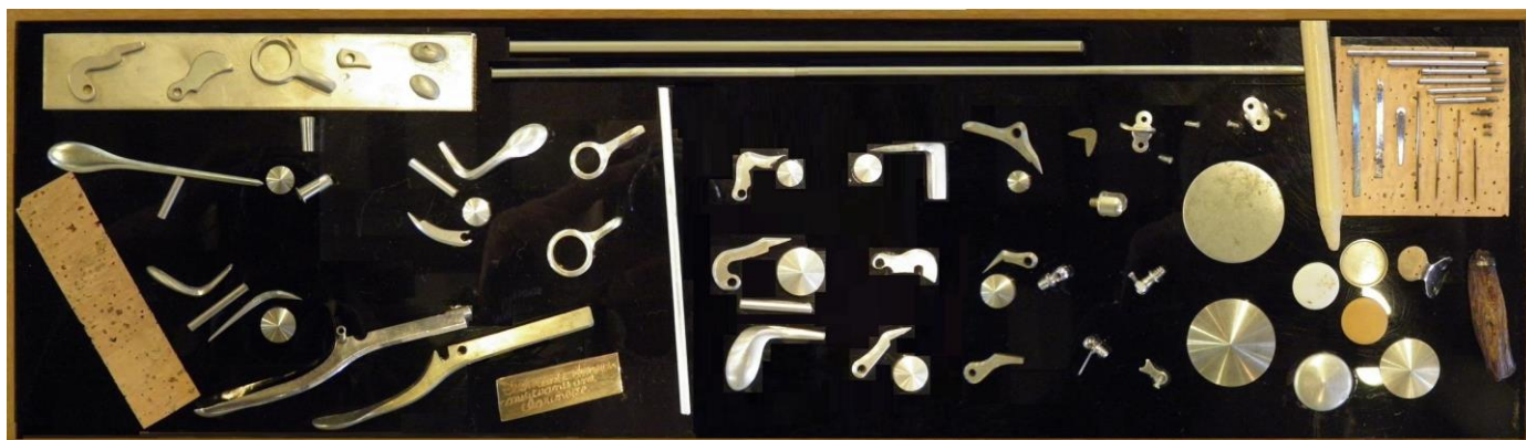
Éléments servant à la fabrication des clés d'une clarinette
