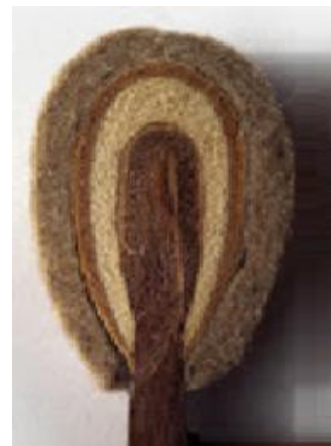
Feutre « Henri Pape » en poil de lapin d'un piano Pleyel de 1845.
