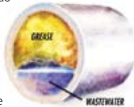
Tubería de alcantarilla obstruida con grasa
