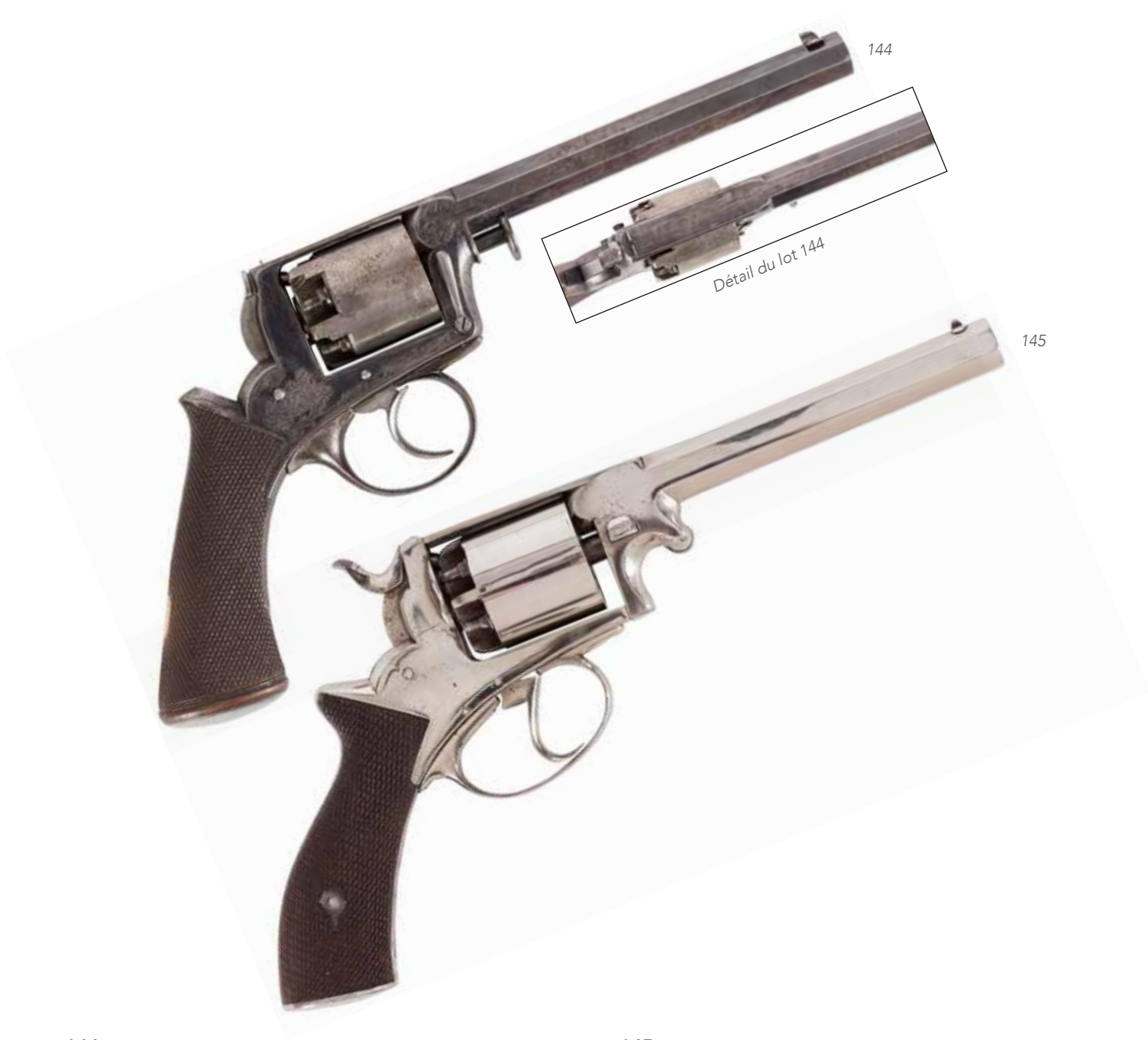
144 REVOLVER À PERCUSSION «ADAMS» MODÈLE 1851, CINQ COUPS, CALIBRE 45, DOUBLE ACTION. Canon à pans, rayé, de 16 cm. Carcasse fermée décorée de rinceaux, poinçonnée «ADAM'S PATENT», gravée sur le côté «ADAM'S PATENT N° 9543» et sur le dessus en lettres gothiques «Leon Leroux Arqer à Paris». Crosse en noyer quadrillé avec pièce de pouce en argent. Finition bleuie patinée à 60%. Longueur: 32 cm B.E. . 1000/1200€
