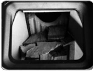
Posez la bûche de bois légèrement inclinée vers l'arrière dans le foyer du poêle. La grille est poussée vers le bas par le poids de la bûche de bois, et l'alimentation en air de combustion est ouverte.
