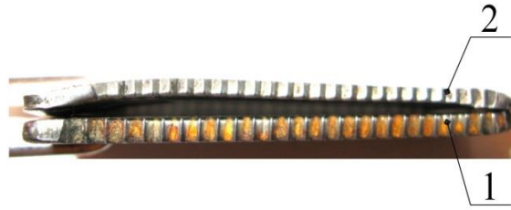
Рисунок 2. Общий вид противорежущих пластин после наработки 6,5 га: 1- упрочненная ЭИО, 2- неупрочненная
