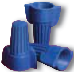
BLUE 14-6 AWG WIRE RANGE: max: 1 #8 w/3 #10 min: 2 #10 w/1 #12 VOLTAGE: 600 volt max**
