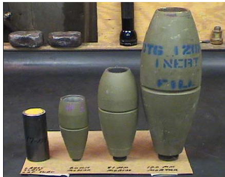
Preparing Mortar projectiles for melt pour loading
