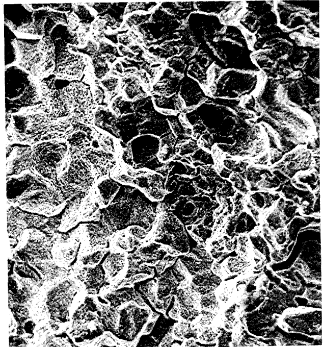
(d) SEM 500X - Corrosion
