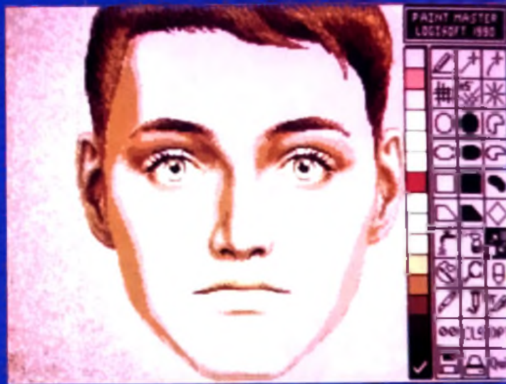
ST : Paint Master travaille en vectoriel, grâce à l'utilisation de courbe spline. Il est possible de modifier les contours du dessin tout en conservant un tracé parfait.
